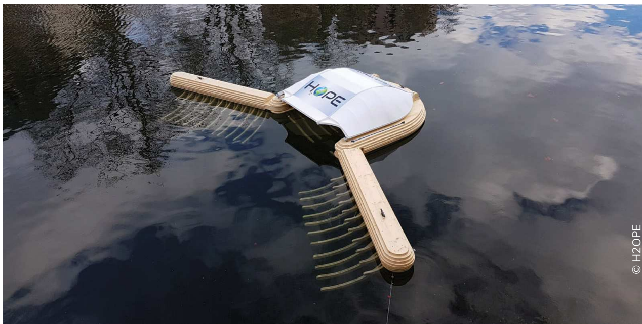
Photo 9. Collecteur de déchets River Whale de la société H2OPE pour le nettoyage des rivières et la protection des océans.
