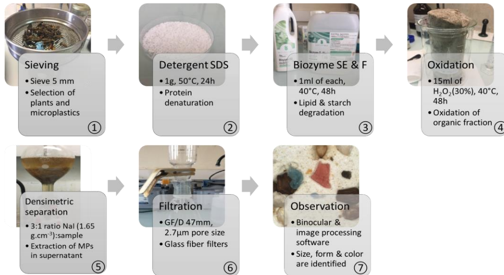
Figure 4 : Etapes de purification des échantillons de MP de la colonne d'eau
